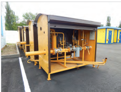
В целях снижения эксплуатационных затрат по реконструкции и модернизации объектов газоснабжения предприятием осуществляется изготовление собственными силами газорегуляторных пунктов и шкафных регуляторных пунктов
